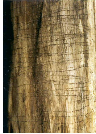
Bild 4: Ringförmiger Fraß im Kambialbereich Foto: N. Zwecker
