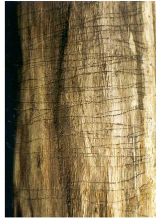
**Bild 4:** Ringförmiger Fraß im Kambialbereich
